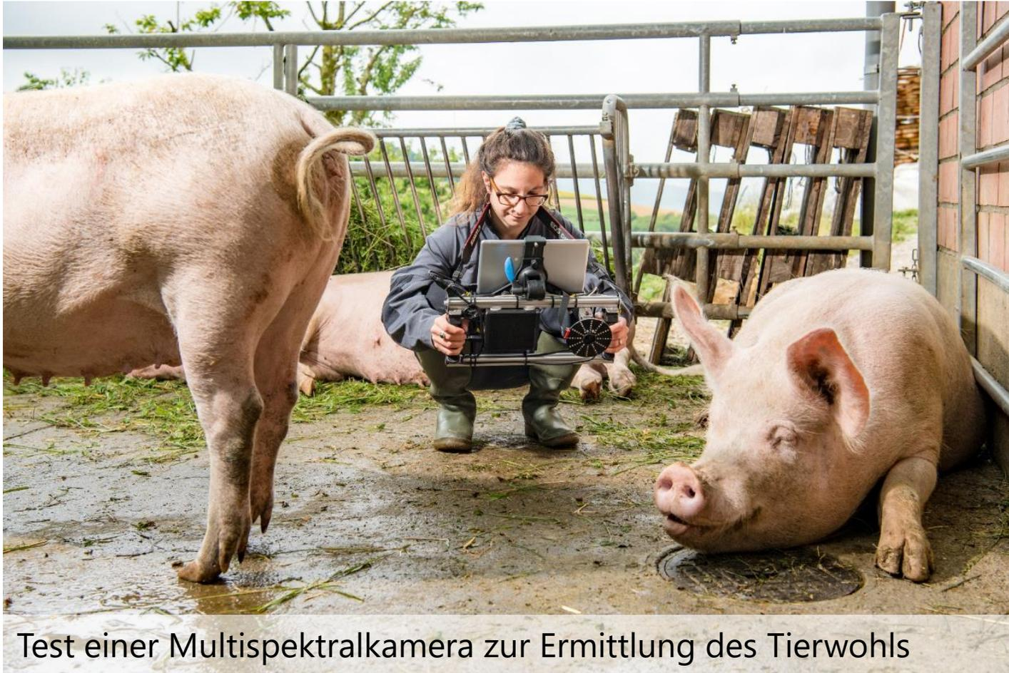
Test einer Multispektralkamera zur Ermittlung des Tierwohls
